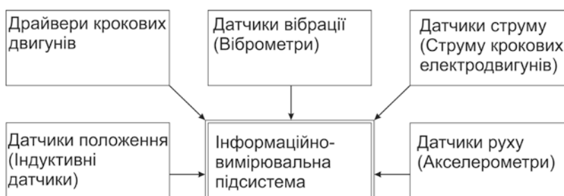
Рис. 6. Структура інформаційно-вимірювальної підсистеми
