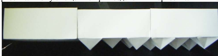
Рис. 4. Макеты фигурных элементов мощения с плоским основанием, с рифленным основанием из пяти зубчатых и пяти звездчатых элементов пирамидальной формы
